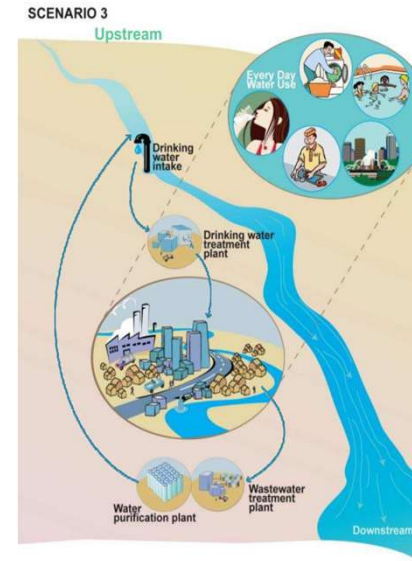
Reutilització potable indirecta amb aportació al riu aigües amunt de la captació
