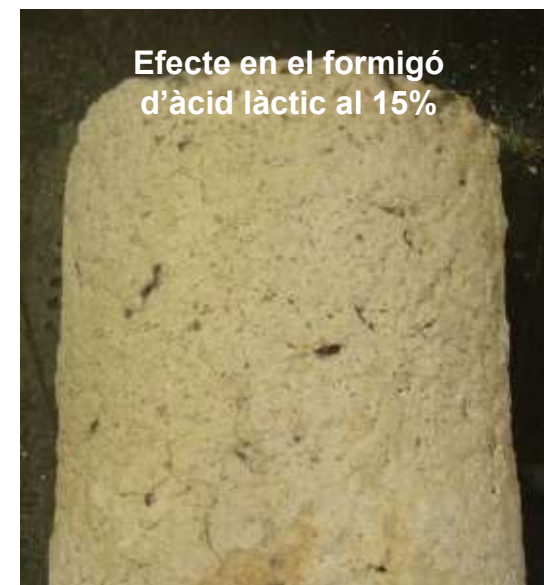
Efecte de la pèrdua de massa per solubilització en el formigó
